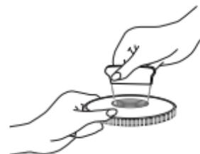
Per allentare il bordo del diaframma, inserire la chiave nelle due fessure della parte filettata, situata sul lato inferiore dell'assemblaggio. Mentre si tiene fermo il bordo, ruotare la chiave in senso antiorario per allentarlo.
