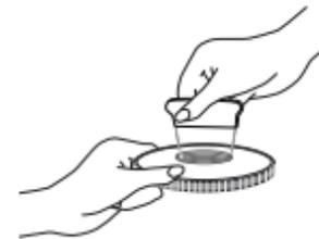
Pour desserrer le cerceau du diaphragme, insérez la clé dans les deux fentes de la partie fileté, située sous l'assemblage. En maintenant le cerceau stable, tournez la clé dans le sens inverse des aiguilles d'une montre pour desserrer le cerceau.
