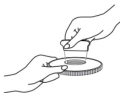
Per allentare il bordo del diaframma, inserire la chiave nelle due fessure situate all'interno della porzione filettata, situata sul lato inferiore del gruppo. Tenendo fermo il cerchio, girare la chiave in senso antiorario per allentare il cerchio. Rimuovere il diaframma indossato e sostituirlo con uno nuovo. Rimontare il bordo e stringere ruotando la chiave in senso orario fino a serrare. Quindi riassemble il bordo del diaframma sul tamburo del torace ruotandolo in senso orario fino a serrarlo.
