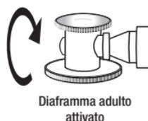
Per selezionare il lato in funzione, tenere il gambo del pettorale in una mano e ruotare il pettorale con l'altra mano fino a sentire un clic. Un leggero tocco sul diaframma o sulla campana aiuterà a determinare quale lato è in funzione.
