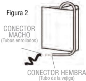
2. Inserte firmemente el conector macho de la tubería enrollada en el conector hembra en el extremo de la tubería de la vejiga AdcuffTM. Asegúrese de que los conectores estén apretados (Figura 2).
