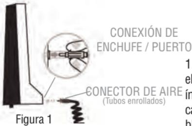
1. Apriete el centro del conector de aire de plástico en el extremo de la tubería enrollada entre el pulgar y el índice, e inserte en el puerto de conexión de aire en la cara del e-sphyg 2TM. Asegúrese de que el conector se bloquee firmemente en el puerto (Figura 1).
