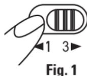
b) Wenn Sie eine Single-Mode-Messung nehmen möchten, positionieren Sie den Schiebeschalter auf der 1. In diesem Modus gibt es nur einen Meßzyklus. (Fig. 2)
