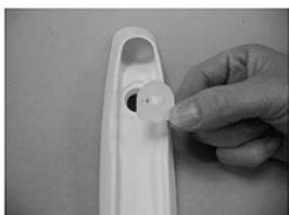
(1) Coloque una cubierta de sonda en el orificio de la caja de almacenamiento con el papel hacia arriba. Alinee la cubierta para que encaje exactamente en el orificio.
