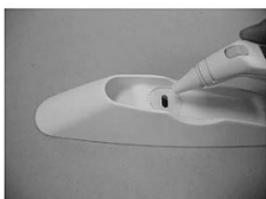
(3) Empuje completamente la sonda dentro del orificio del soporte de la cubierta de la sonda. Empuja firmemente.
