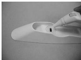
(2) Tome la unidad, penetre verticalmente la sonda en la parte central de la cubierta de la sonda.
